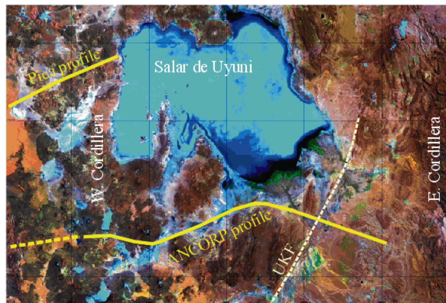
Abb. 1: Satellitenbild des Altiplano mit Lage der magnetotellurischen Profile (durchgezogene Linien; gestrichelte Linie: geplante Verlängerung 1998). Senkrecht zur Uyuni-Keniani-Fault (UKF) wurde ein detaillierteres AMT-Profil vermessen.
